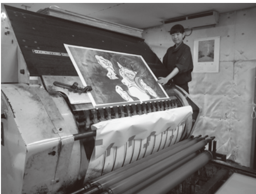
紙(手漉き和紙)を機械に差す印刷助手
